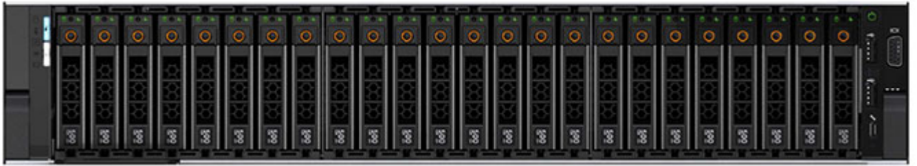
R740xd の前面図 : 24 x 2.5 インチ ハードドライブ構成
