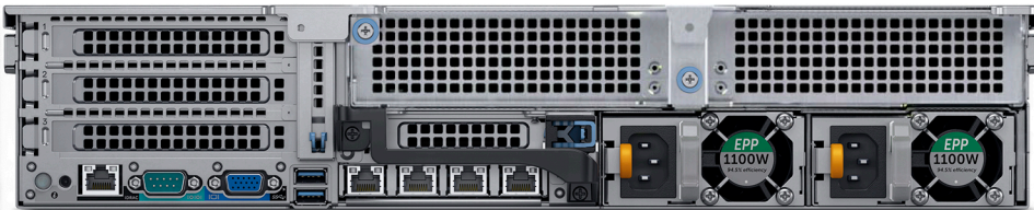
R740 の背面図 : ライザー 2 およびライザー 3 ダミーで利用可能な 4 個の PCIe スロット
