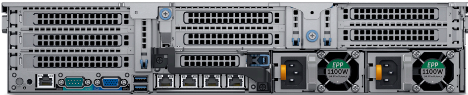
R740 の背面図 : ライザー 2 およびライザー 3 ダミーで利用可能な 4 個の PCIe スロット
