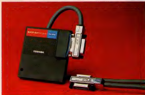
◆東芝から発売されたGP-1Bカートリッジ「HX-GP10」。IEEE 488準拠のインターフェイスで、各音制御機とMSXを接続する。
