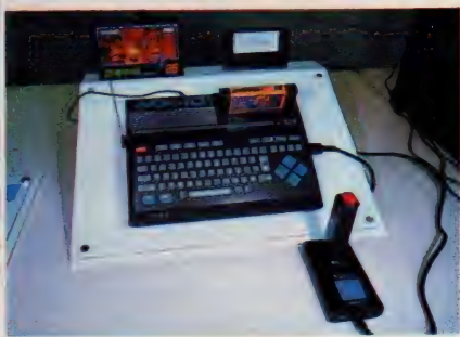
◆見てビックリのワープロユニット。24ドットのプリンタが一緒になった。 ◆UHF波で電波を飛ばす、カシオのワイヤレスMSX「MX-101」。
