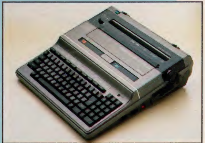
↑松下・FS-4700。FS-4500に2DDのディスクドライブを1機内蔵。
