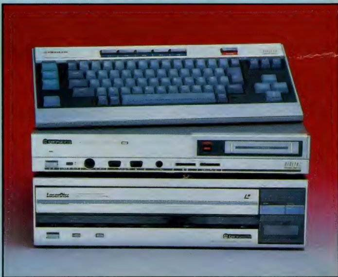
↑ヤマハのYIS503。FM音源ユニットなど底面の専用スロットで音楽ソフトに対応。
