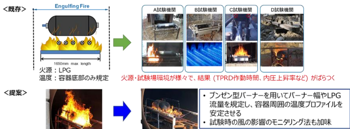
Fig. 5 容器火炎暴露試験法の改定内容検討
