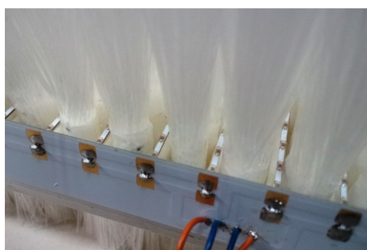
図 3.17: モジュール内の赤外線 LED
