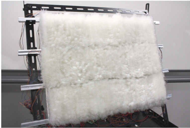
図 3.18: 実装した毛状マルチタッチディスプレイの概観
