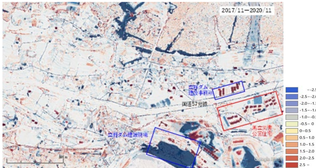
図6 立野地区の2017/11-2020/11の期間におけるDSM差分(図2の黄色枠内)
