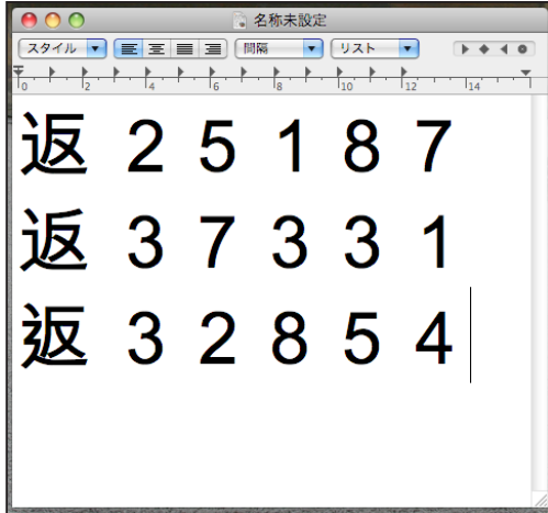
図9 Arial Unicode MS に隠されているグリフ。上段から通常のグリフ、中国（大陸）デザイン、台湾・香港デザインとなっている。右の番号はフォントファイル内部でのグリフ番号
