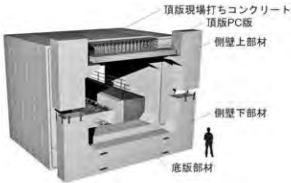
図一 11 HPCa ボックスカルバートの概要
