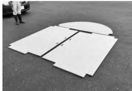
写真一八 紙素材のダムの監査廊用扉の構成
