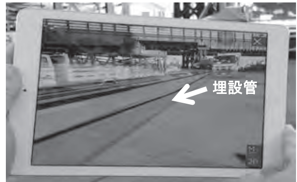
写真一七 タブレット端末の表示画面（カメラ画像に埋設物図面を投影）
