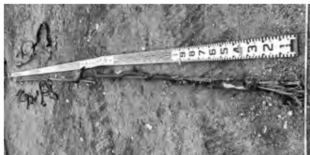
写真-2 回収された鋼線
