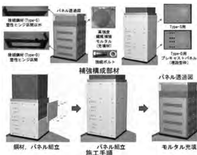
図-8 CBパネルの部材と施工手順
