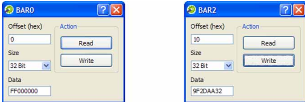
図 5.9: メモリおよび I/O の Read / Write
