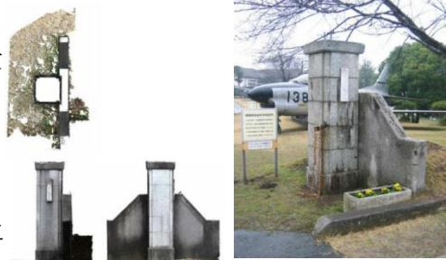
②熊本幼年学校「右脇門」オルソ図 ③右脇門・擁壁の現況
