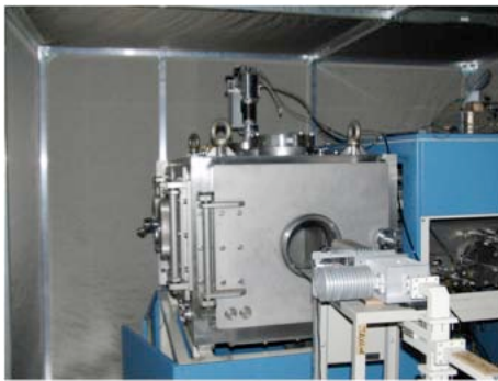
電磁シールド内に設置されたチャンバーとマイクロ波導入系
