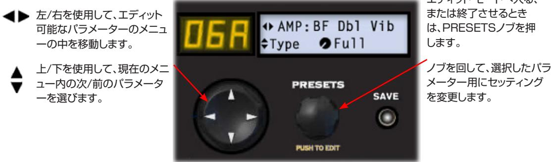
**ヒント:** 最後にアクセスしたエフェクト・モデル・タイプのために、直接エディット・モードへアクセスすることも可能です。例えば、**REVERB**ノブを回して調整した後、直ぐに**PRESETS**ノブを押せば、そのReverbエディット・モード・メニューを呼び出すことができます。
