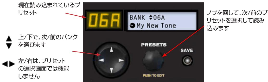
黄色のLEDインジケーターとLCD画面の最上段で、現在のプリセット・アドレスを示します。◆ナビ・ディスク機能を使用して、バンクを1つずつ表示させながらプリセットに目を通します。
