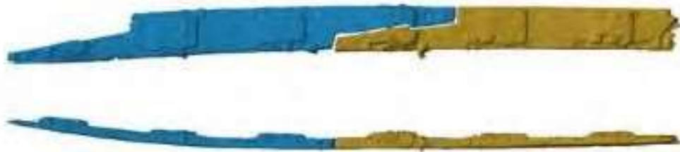
図 3-8. 船材端部の斜め継ぎ接合例 CT-T10(右)とCT-T11(左)
