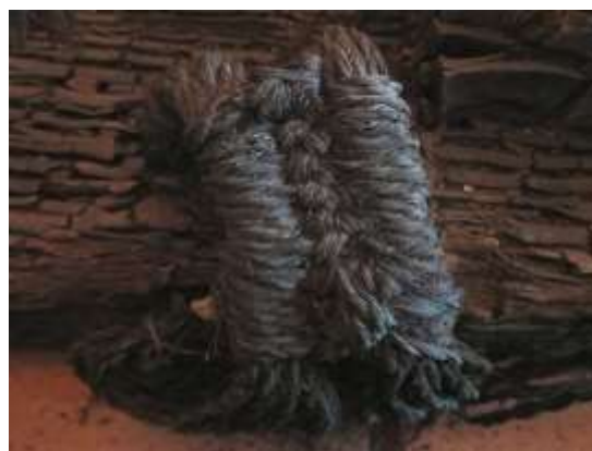
図 3-7. ヤシ葉鞘繊維で編んだ紐と紐の補強材
