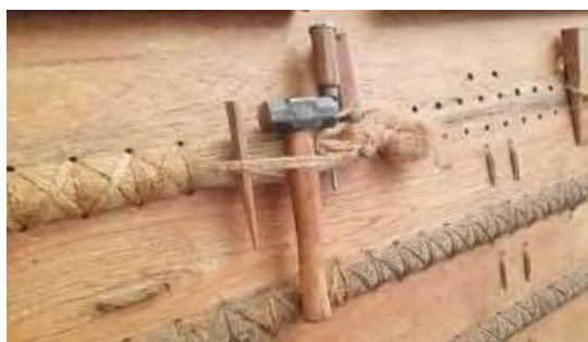
図 4-3. インド洋のダウ船の外板縫合法(写真: Tom Vosmer)
