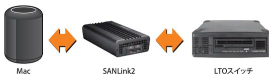
タンベルグデータLTO-7ハーフハイト(HH)テープドライブは手頃な価格で中小企業に企業水準の容量と性能を提供します。LTO-7 HHドライブは単一で最大15TBのデータを保存可能であり、最大2.7TB/hの性能を誇ります。LTO-7 HHテープドライブは、書き込みでは1世代下位互換性、読み込みでは2世代下位互換性を有します。LTO-7 HHテープドライブはLTFS、WORM、AES 256ビット・ハードウェア暗号化をサポートしており、オフサイトに保存または輸送中のデータを最大限保護します。LTO-7 HHテープドライブはSASインターフェースを搭載し、内蔵、外付けから選択できます。また、3年間のセンドバック保守サービスが付帯します。
