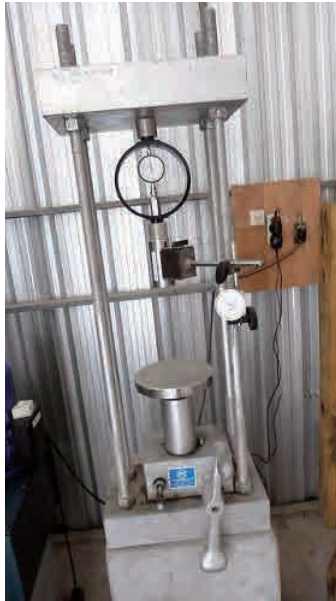
CBR 試験装置（路床土支持力を測定）
