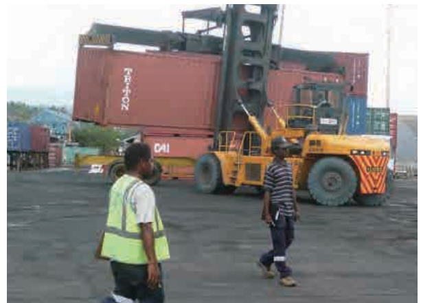
トップリフターがコンテナをトレーラーへ積み込む
