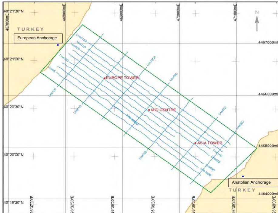
図 3.4.7 沖合海底地形調査のトラックライン
