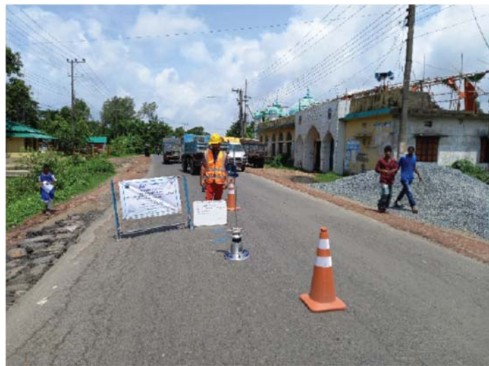
図 9.1.15 (写真) 小型 FWD 試験実施状況
