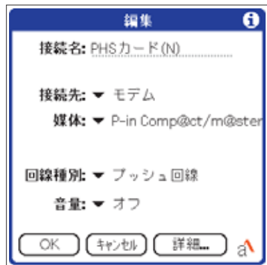
図2 環境設定の「接続」の編集画面。ここで最も気をつけたいのは「媒体」欄だ。通信カードに合ったものを選択すること
