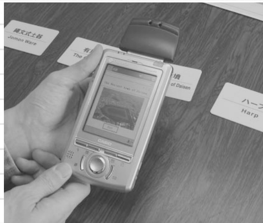
写真1 ICタグが埋め込まれたカードに、CF型ICカードリーダーを装着したPDAをかざすと、写真や説明文が表示される
