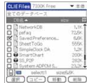
図 「SavedPreference」には、Palmデバイスにインストールされているソフトの設定情報が記録されている。削除しても新しいものが作成される
