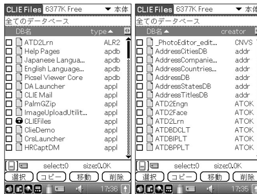
図 CLIEに付属するCLIE Filesでファイルタイプ(左)とクリエイターIDを表示した例。ともに4バイトの値を持っていることがわかる
