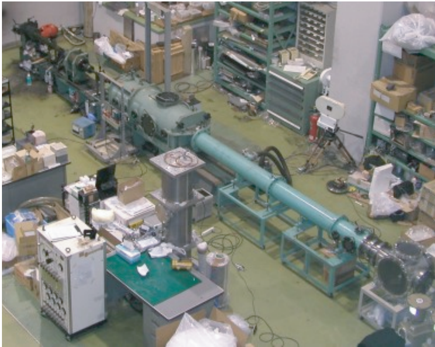
Fig. 2-4: 二段式軽ガス銃の概観.
