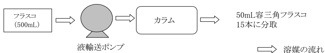
図 3-3-3 中圧液体クロマトグラフィの概略図
