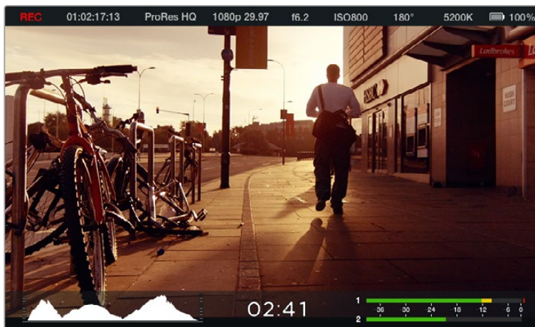
Blackmagic Micro Cinema Cameraのオンスクリーンメーターとステータス・ストリップ。
