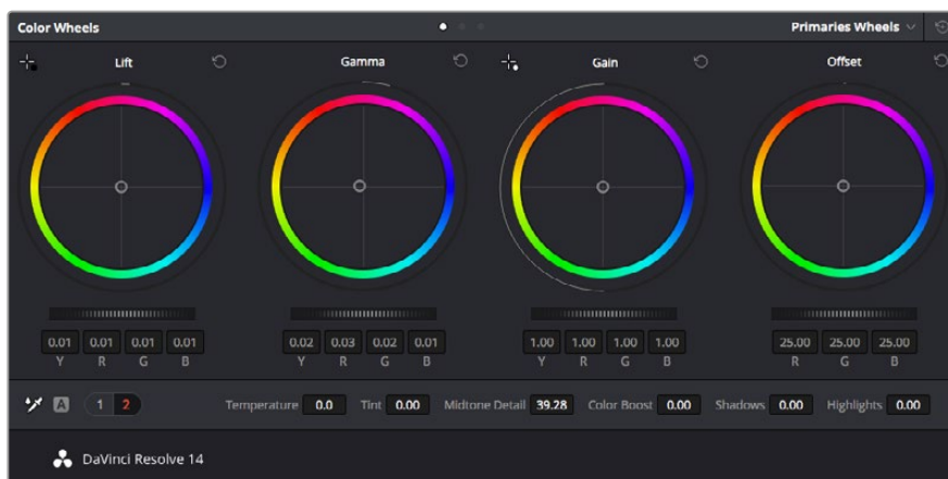
Die Farbräder „Lift“, „Gamma“, „Gain“ und „Offset“ geben Ihnen die volle Kontrolle über die farbliche und tonale Balance Ihrer Clips. Um für jede Farbe eines jeden tonalen Bereichs einheitliche Anpassungen vorzunehmen, bewegen Sie das Einstellrad unter den Farbrädern hin und her
