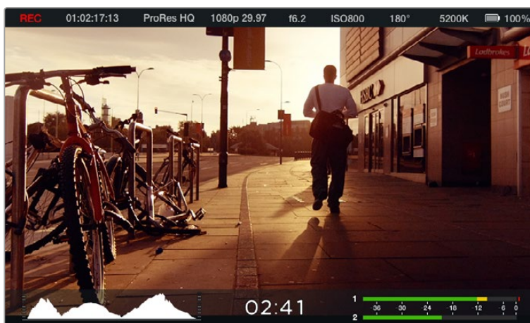
Medidores e faixa de status na tela da Blackmagic Micro Cinema Camera.
