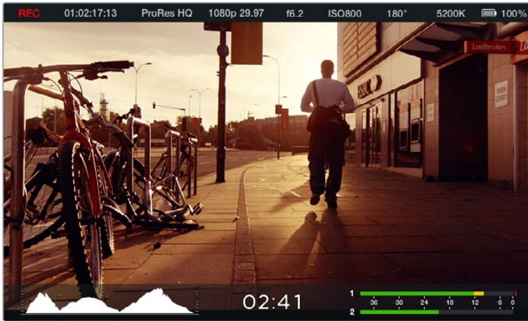
Blackmagic Micro Cinema Camera의 온스크린 미터와 상태 스트립
