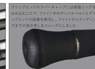
ベイトモデル86M/Bのフォアグリップはラバーグリップ仕様にする事で、滑りにくく力を入れやすくすることで、しっかりとロッドをホールドし、リールが下に向くのを防ぎます
