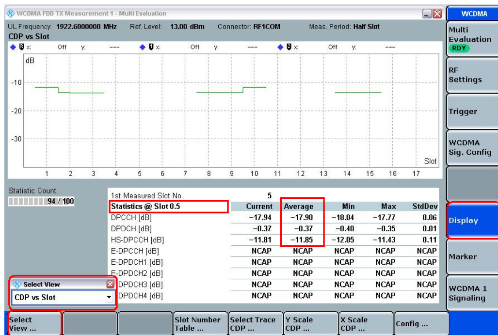
図 20 : コード・ドメイン相対パワーの測定結果
