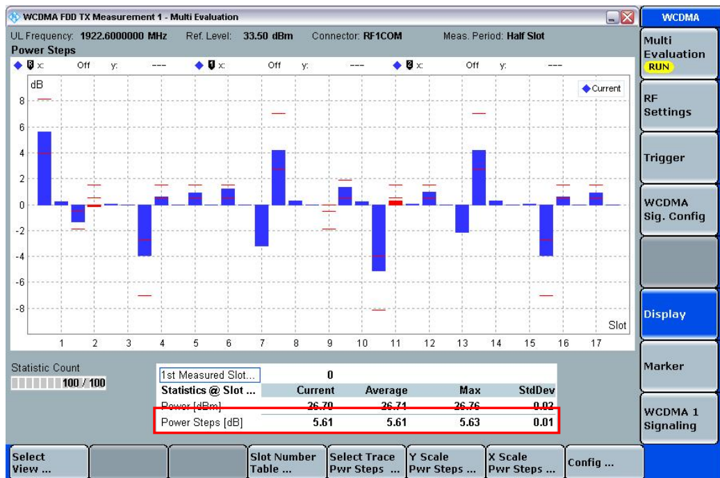
図 26 : 測定ポイント 1 の周囲 of パワーステップ測定 (TPC_cmd=1 の場合)
