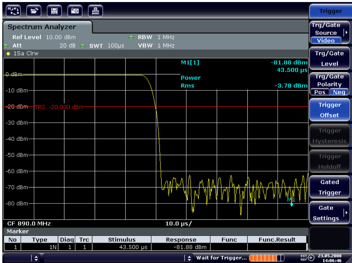
図 6-10: 時間分解能を上げて GSM バーストの立ち下がリエッジを表示
