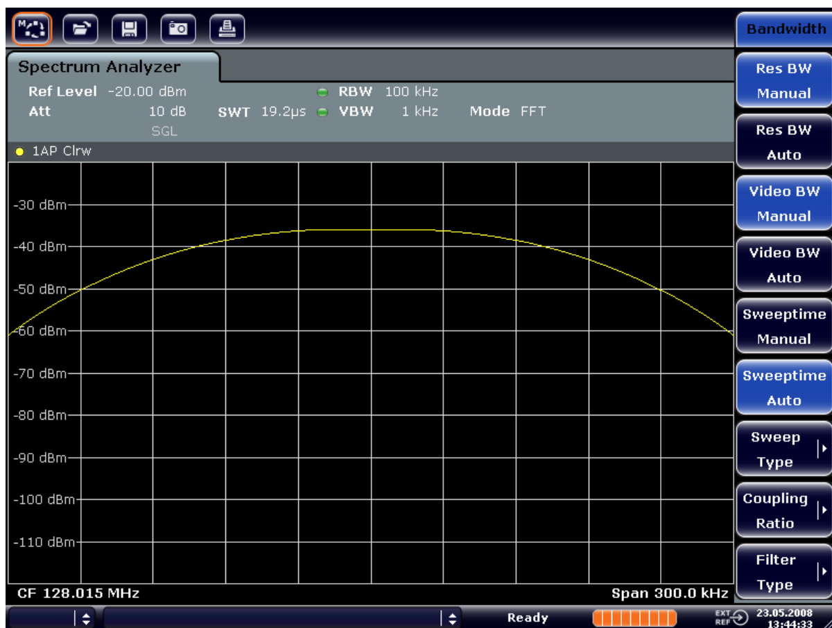
図 6-5: 同じレベルの 2 つの RF 正弦波信号を、信号の周波数間隔より広い分解能帯域幅で測定した結果
