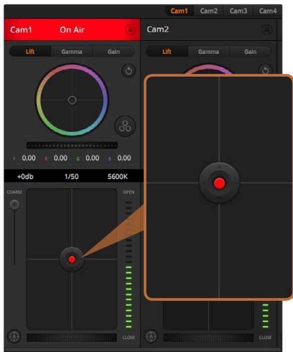
当某台摄影机处于直播状态时，对应的光圈/黑电平控制按钮会亮起红色。
