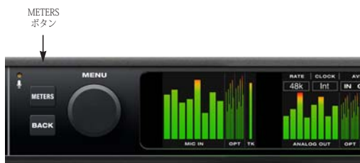
図7-1: METERS ボタンを押すと、LCD 表示を順にメーター、アクティビティインディケータ、ステータス表示に切り替えます。
