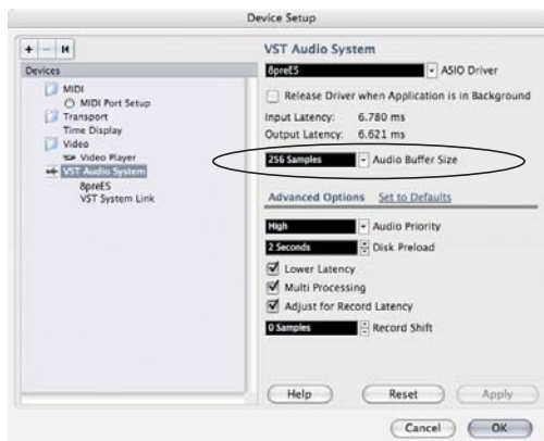
図 8-3: Cubase や Nuendo では、デバイスメニューより「Device Setup」を選び、「8pre-es (またはその他の MOTU インターフェイスモデル)」を選択した後、「Audio Buffer Size」で設定を行います。
