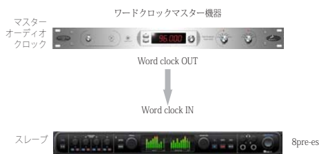
図 5-18: 8pre-es システムをワードクロックにスレーブ。8pre-es のクロックソースには、“Word Clock In” を選択します。
