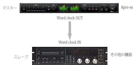
図5-17: 8pre-es経由でデジタルオーディオデバイスをMOTUインターフェイスシステムにスレーブ。8pre-esのクロックソースには、ワードクロック以外を選択します。
