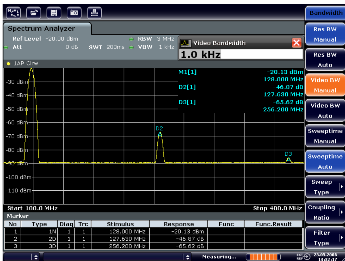
図 6-3: ビデオ帯域幅の縮小による高調波測定時の雑音を抑圧
