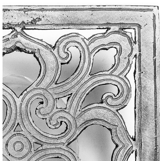
図30 研磨後の線彫り
