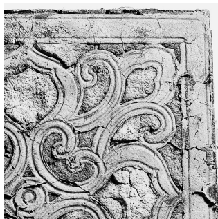
図29 鋳込み直後の線彫り
