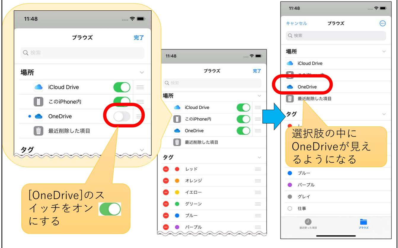
OneDriveを保管場所として選べるようにするために、[OneDrive]のスイッチをオンにします。
