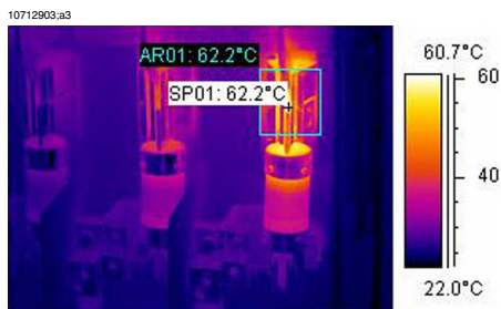
図 29.3 最高温度が表示されたヒューズボックスの熱画像
