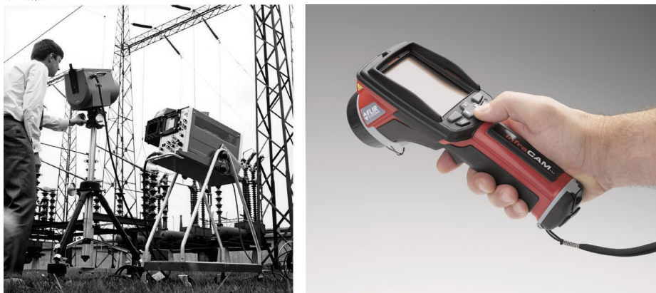
図 30.1 左: 1969 年型 Thermovision® 661 モデル。カメラの重量は約 25 kg で、オシロスコープが 20 kg、そして三脚は 15 kg でした。操作するには、220 VAC ジェネレーター一式と 10 L (2.6 US ガロン) の液体窒素が必要でした。オシロスコープの左にはポラロイドカメラ (6 kg) が取り付けられているのが見えます。右: 2006 年型 InfraCAM。重量: 0.55 kg (バッテリー込み)
