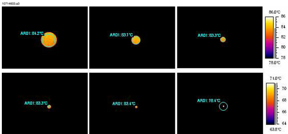
図 29.20 距離を遠ざけながら +85°C 黒体から読み取った温度 (24 レンズ)
