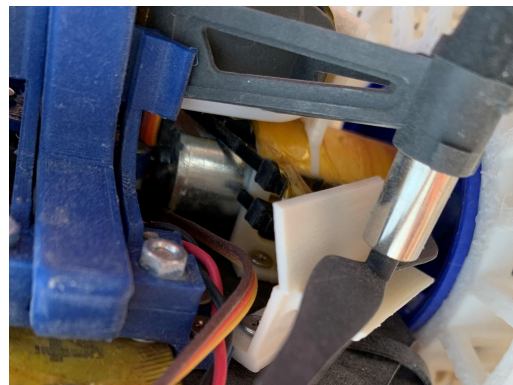
図 9.20 結束バンドの切断によるモータ損傷
