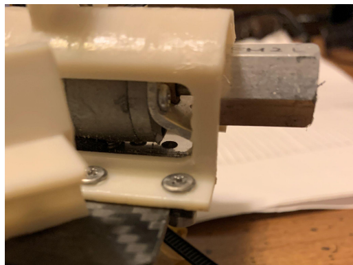
図 9.19 変形したモータブラケット
