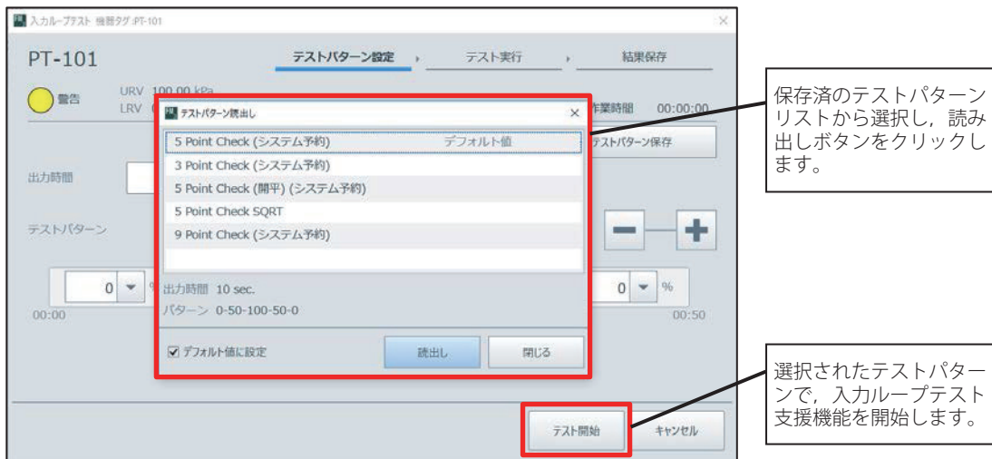
図 H-2-20 入力ループテストサポートのテストパターンの読み出し
