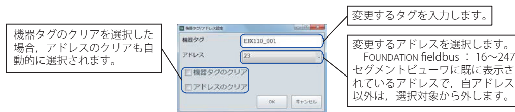
図 H-3-2 FOUNDATION fieldbus H1 機器タグ/アドレス設定
