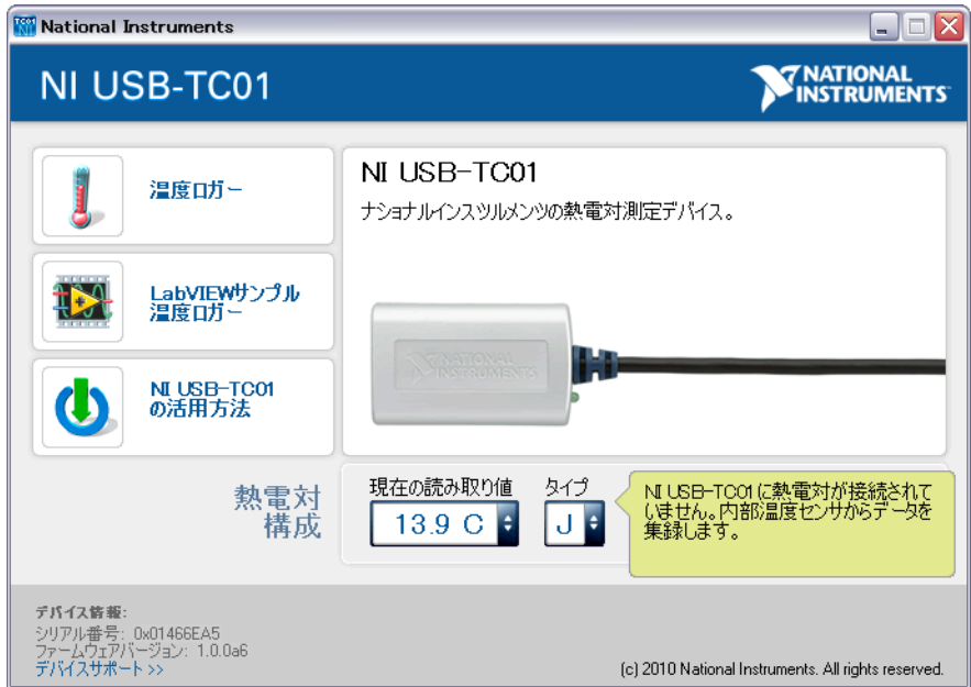
図 8 NI USB-TC01 ソフトウェア熱電対断線メッセージ
