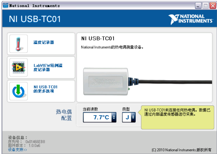
图 8 NI USB-TC01 软件开路热电偶消息
