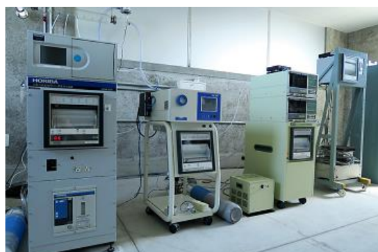
各測定機（左から窒素酸化物計、オキシダント計、 二酸化硫黄・浮遊粒子状物質計）
