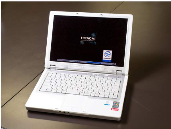
2004年末に垂直磁気記録方式のプロトタイプとして試作されたHDD搭載のノートPC。稼働実績を蓄積するために1年にわたるフィールドテストが実施された
