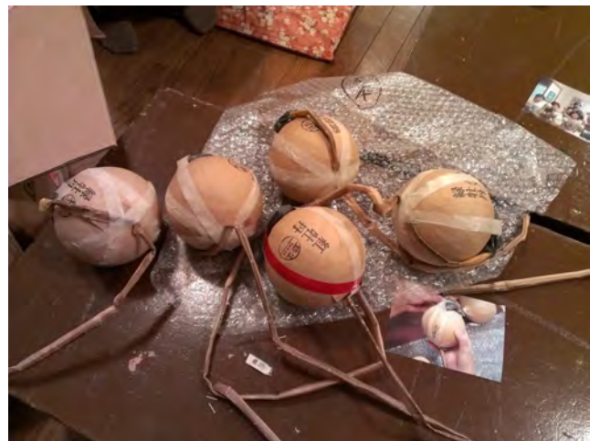
図4 黒色火薬固定完了
