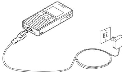
ACアダプタのコネクタを刻印面を上にして本機のUSB端子接続部に接続する
