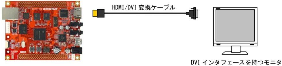
Fig 3.3-2 DVI インタフェース接続例
