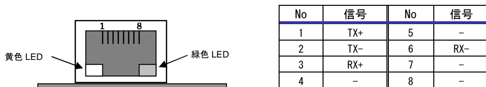
Fig 3.3-2 LAN ポートコネクタ (P1 正面)
