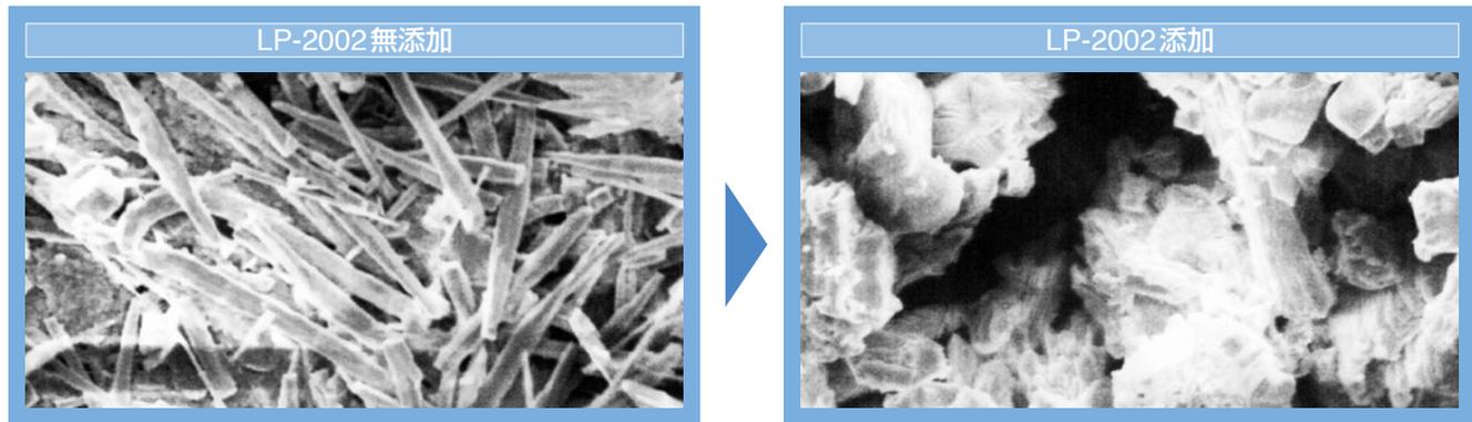
アクアスハイパー LP-2002のスケール防止効果によりシリカスケールの結晶破壊が起こり、スケールの成長、付着を防止します。
