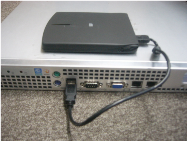
図 5: ノード計算機のセットアップ. USB 接続の CD-ROM ドライブを用いて起動することで, ノード計算機のコストを削減できる. 必要に応じて, BIOS 設定を変更し, 起動デバイスを USB 接続の CD-ROM ドライブに設定する.
