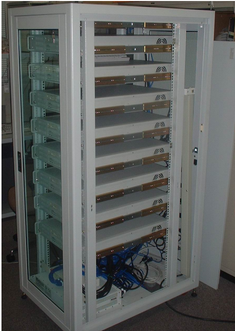
図 1: 第 2 世代の PC クラスタ。高さ 2U の筐体に 866MHz の Pentium III プロセッサを 2 個、ネットワークインタフェースとして Myrinet を装着。8 ノード、16 CPU 構成の PC クラスタ。オペレーティングシステムに Linux を採用。
