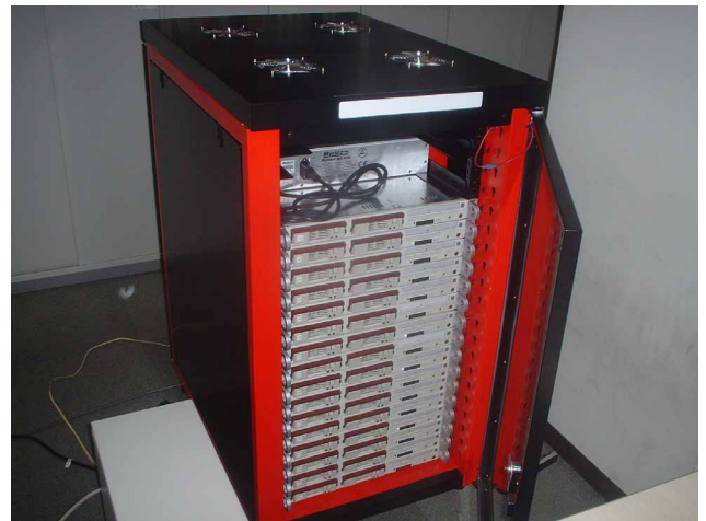
図 2: 第 3 世代の PC クラスタ。高さ 1U の筐体に 866MHz の Pentium III プロセッサを 2 個、ネットワークインタフェースとして Myrinet-2000 を装着。16 ノード、32 CPU 構成の PC クラスタ。システムソフトウェアとして SCore を採用。
