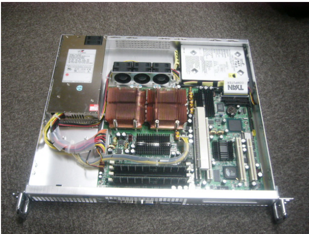
図 4: ノード計算機として用いる Proside SV t2150-mini の内部．高さ 1U の筐体に 2.8GHz の Xeon プロセッサを 2 個，DDR266 デュアルチャネルのメモリを 1GB 搭載する．マザーボードには 1000Mbps のネットワークポート 1 つと，100Mbps のネットワークポート 1 つを持つ．今回の構成では，右上のハードディスクは使わない．
