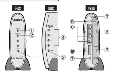
① POWERランプ(緑) - 点灯:ACアダプタ接続時 - 消灯:ACアダプタ未接続時
