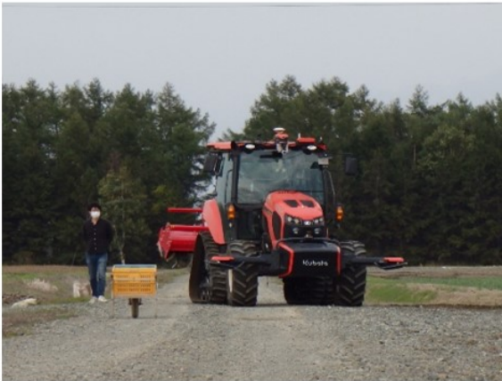
障害物を遠隔操縦で回避するロボットトラクター
