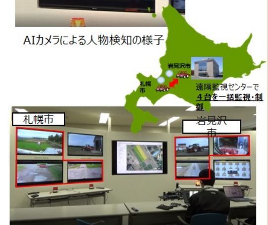
複数箇所に配置したスマート農機の遠隔監視の様子
