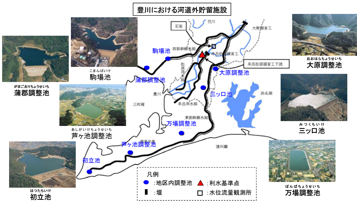
図 4.3.2 豊川における河道外貯留施設
