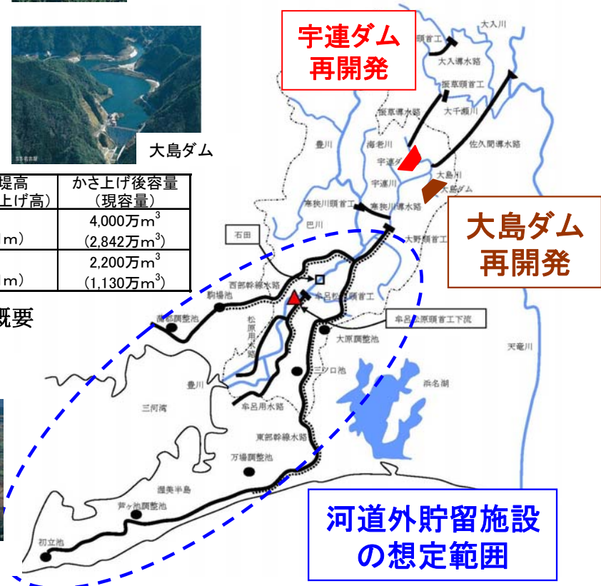
図 4.4.11 河道外貯留施設+ダム再開発(宇連ダム、大島ダム)対策案の概要
