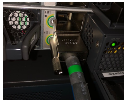
StackPower ケーブルを 1 本取り付けした状態
