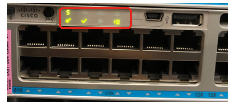
StackPower 動作時の LED 表示
