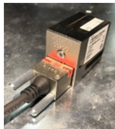
スタック ケーブルを取り付けた状態
