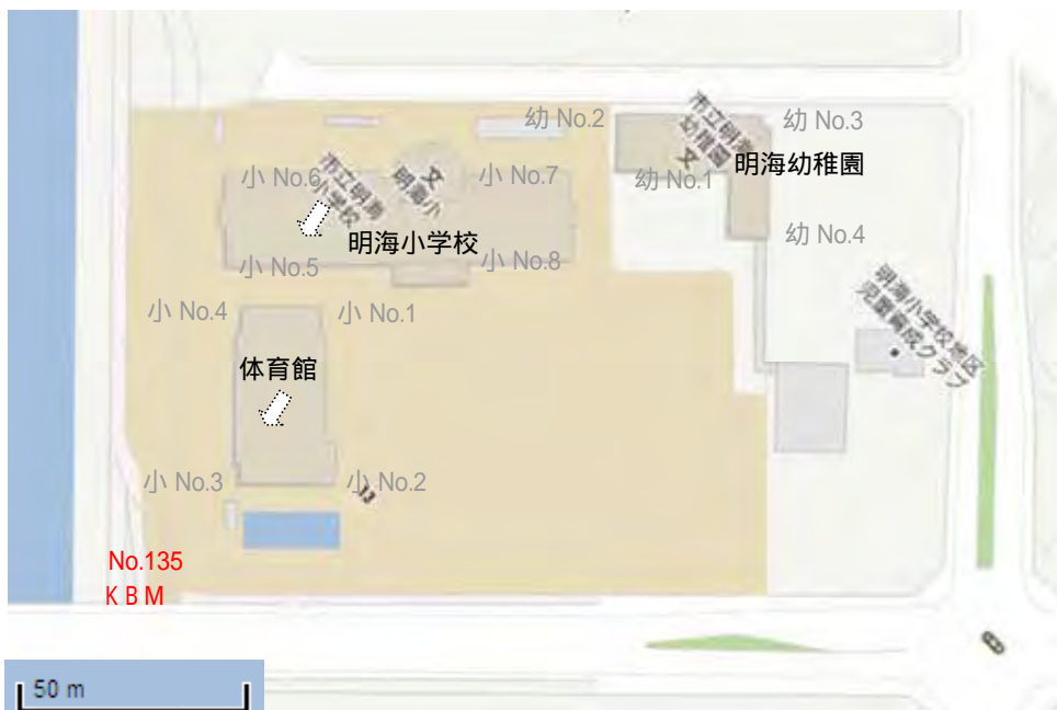
注) 図中の矢印のスケールは概略のイメージとして表示 図-2.1 (3) 各棟の沈下傾斜の概要
