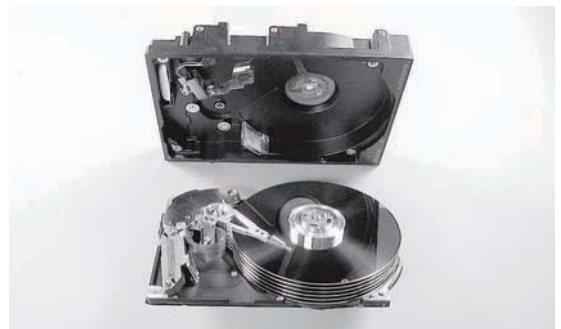
写真A 3.5インチ・ハード・ディスク・ドライブの内部
