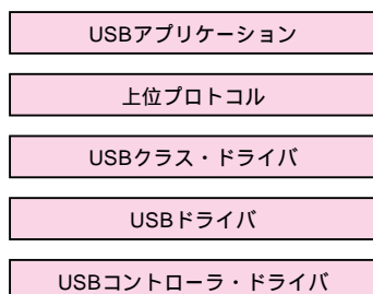
図3 USB ソフトウェアの基本構成
