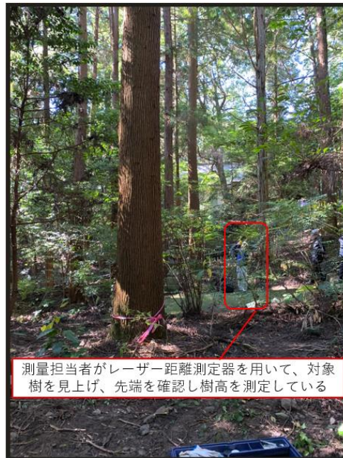
図 3-E-10 従来手法での人での樹高測定の様子
