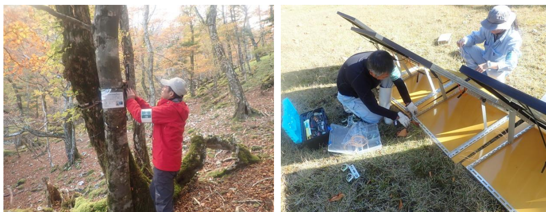
図 2-A1-7 LTE トレイルカメラ及び Starlink 監視カメラの設置作業状況
