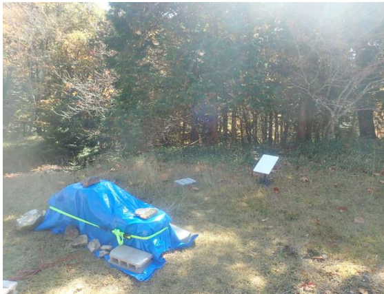
Starlink 監視カメラのバッテリー (ブルーシート内のコンテナに収容) 及び Starlink アンテナ設置例 (C55 地点)
