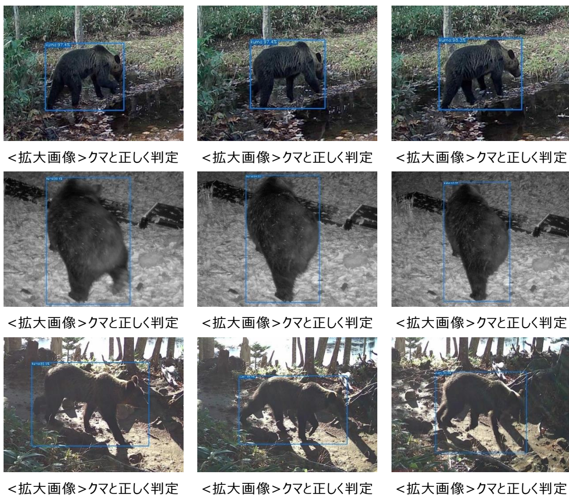
図 3-A2-10 SD カード内画像によるクマ検知結果（拡大・クマと正しく判定）
