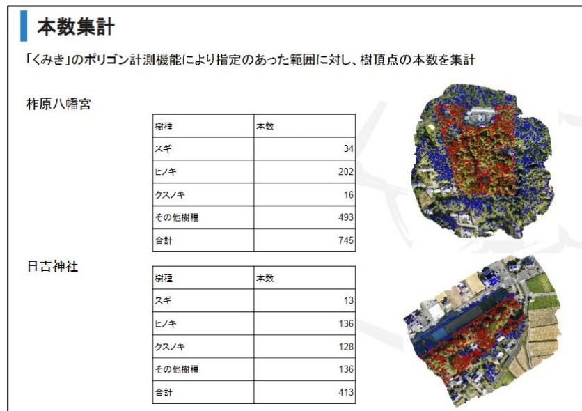
図 3-E-6 ポリゴン計測機能による立木本数計測結果
