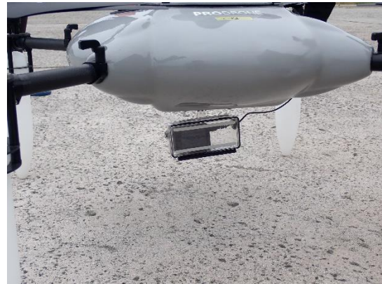
着水型ドローンの機体に装着された GoPro
