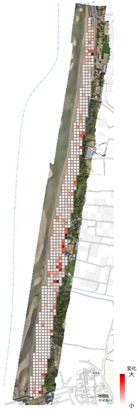
図 3-D-27 植生活性度（正規化植生指標・NDVI）の差分抽出結果
