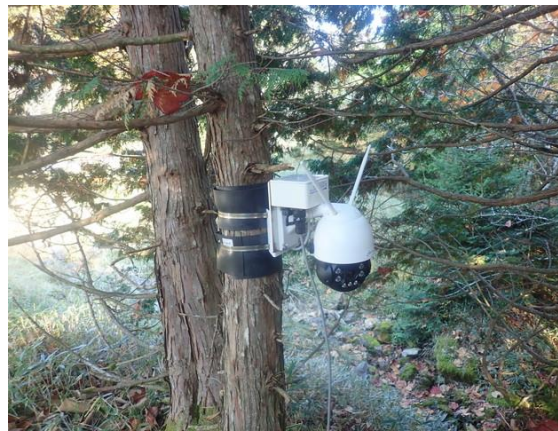
Starlink 監視カメラ設置例② (C55 地点)
