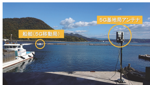
写真1 陸地に設置した5G基地局と船舶に搭載した5G移動局
