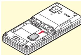
※ microSDカードを取り外すには、microSDカードを軽く押し、飛び出させてから引き出します。
